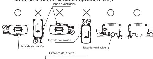
Figura 2-1: Posiciones correctas de una tapa de ventilación
